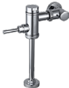
Fluxómetro mecánico de 6 litro para urinario 2121V23003000 Manija y tubo de descarga en acero inoxidable, descarga indirecta.
