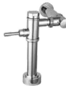
Fluxómetro mecánico de 4.8 litros para inodoro 2121V23031000 Manija y tubo de descarga en acero inoxidable, descarga indirecta.
